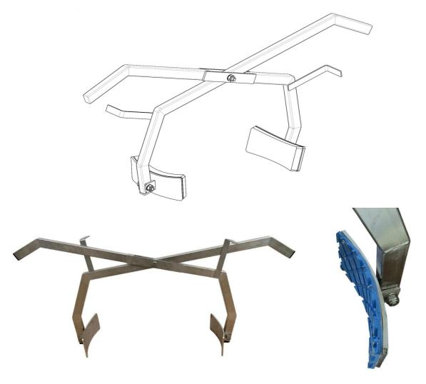
Pinza SOLLEVA FORME INOX AISI304 brevettata, a due maniglie per sollevamento ottimale di forme di formaggio di varie grandezze e peso, leveraggio contrapposto in tubolare 30x20 mm con doppio piatto laterale sagomato.
